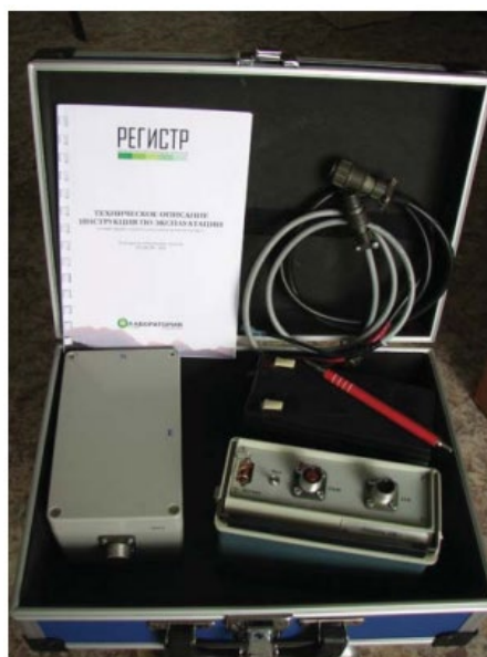
Рис.33. Внешний вид регистратора сейсмических сигналов «Регистр-3MS» в комплекте
